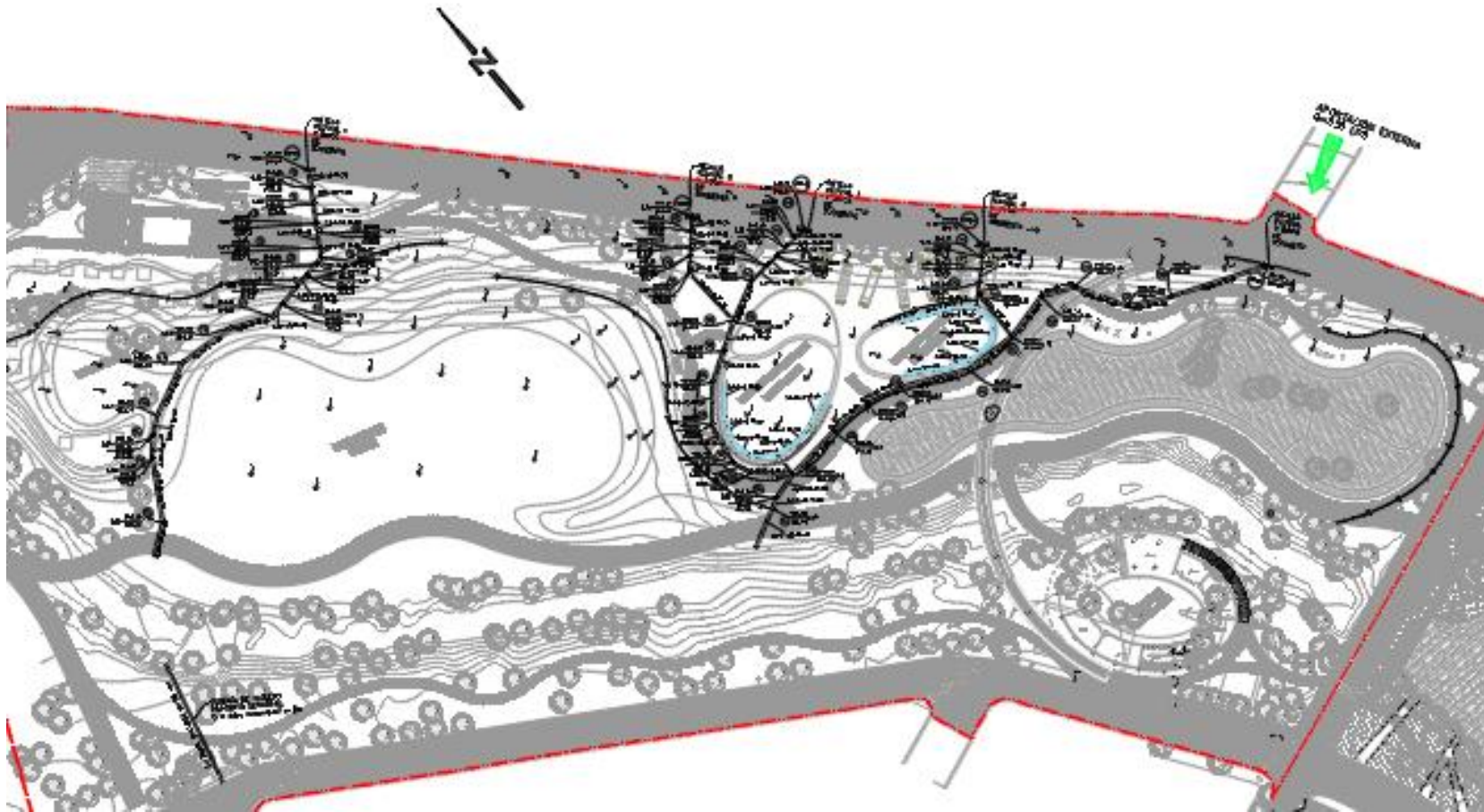
Figura 3. Drenaje Pluvial Zona C
