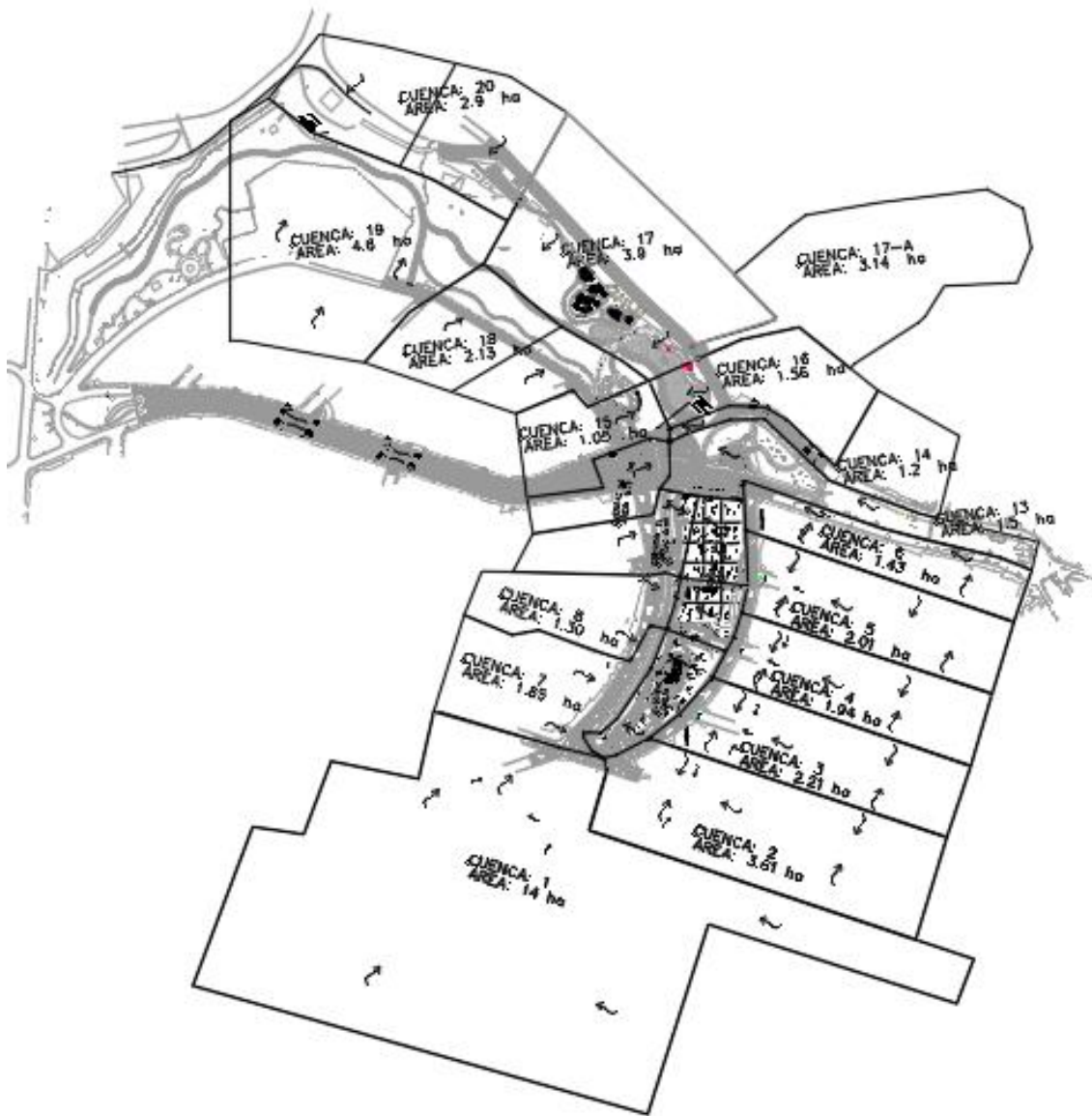
Figura 1. Cuencas de Drenaje Pluvial
